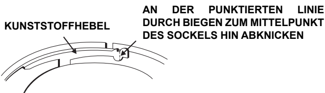
Abbildung 3b: Entfernen des Melders aus dem Meldersockel
