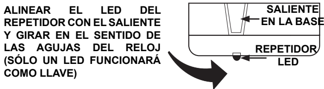
Figura 3a: Activación de la función anti-manipulación
