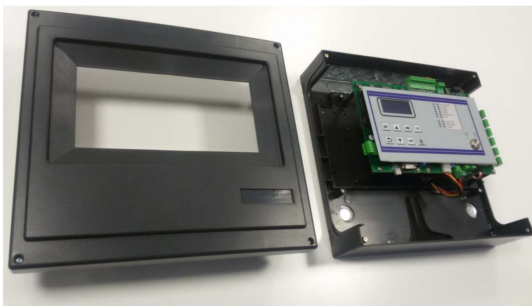
Fig. 2-1) Caja de la central
