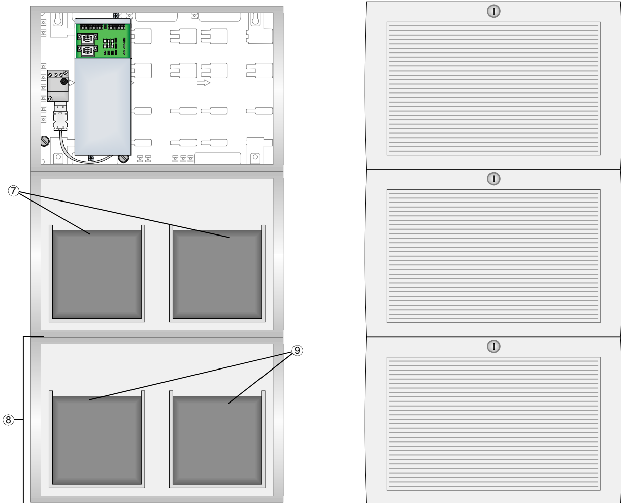
Fig. 14: Ampliación de PSU 24 V / 24 Ah (Referencia: FX808364) incl. Componentes adicionales disponibles
