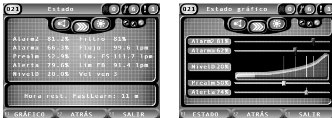
Figura 22: Pantallas del estado del detector
