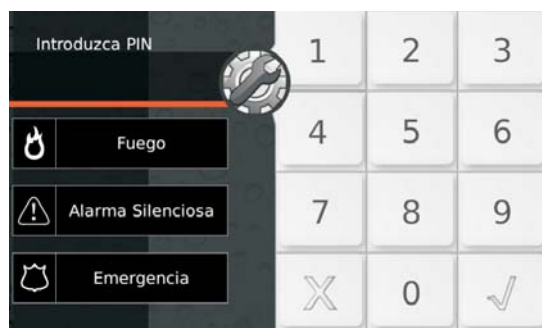
Figura 24 Etiquetas de Fábrica de las Súper Teclas del TecladoTouch.
