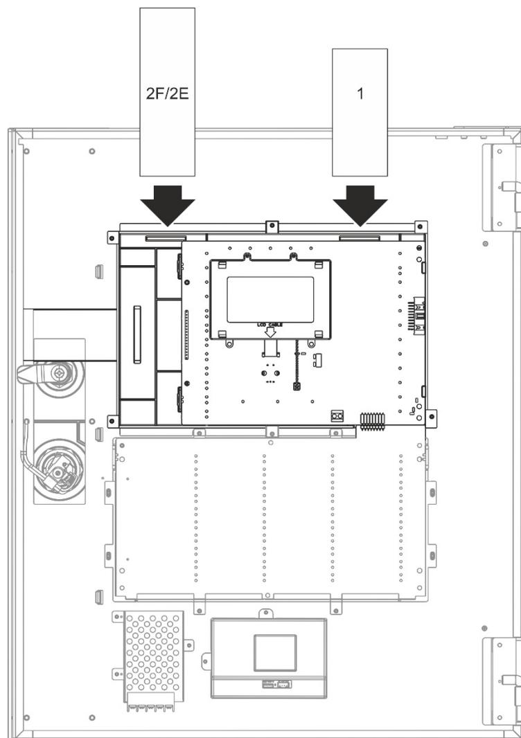
Cada parte insertable está numerada como 1 y 2F/2E, y se inserta en la ubicación indicada arriba (con la zona impresa mirando hacia la parte delantera de la central).
