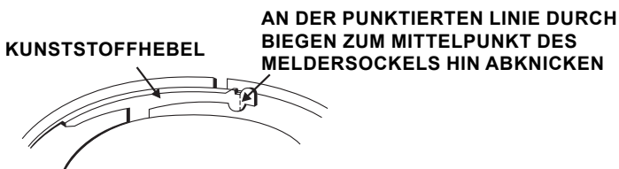
Abbildung 3a: Aktivierung der Entnahmesicherung
