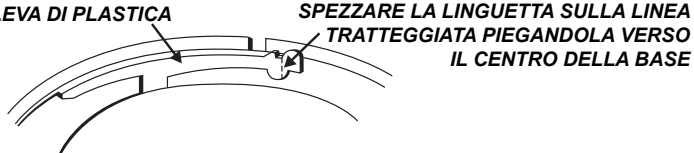
Figura 3a: Attivazione della funzione anti manomissione
