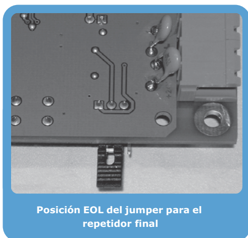
Figura 25 - Módulo SmartLetUSee/LCD-Lite - posición del jumper
