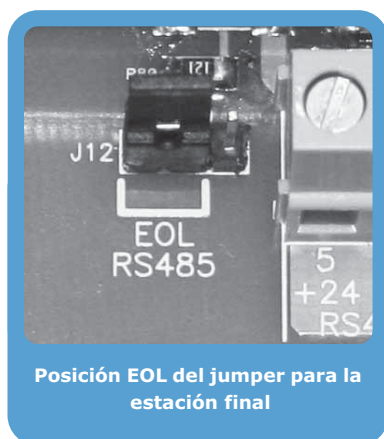
Figura 26 - Módulo SmartLevel - posición del jumper
