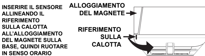
Figura 2: Montaggio del sensore sulla base
