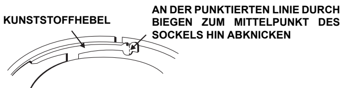
Abbildung 3b: Entfernen des Melders aus dem Meldersockel
