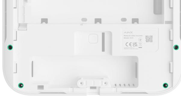
**7. Deslice los cierres y retire con cuidado ambas placas, manteniéndolas en el mismo plano y sin desconectarlas. Hay conectores entre las placas; no los rompa.**
