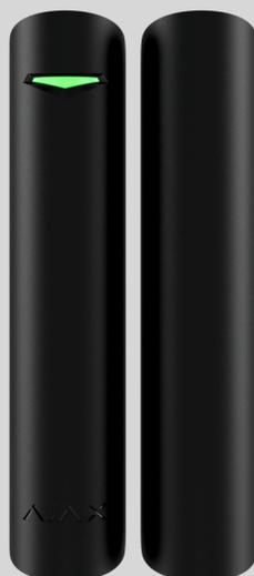
El **DoorProtect S Jeweller** es un detector inalámbrico de apertura de puertas y ventanas diseñado para su uso en interiores. Puede funcionar hasta 7 años con la batería preinstalada. El DoorProtect S tiene un conector para un detector cableado de terceros.
