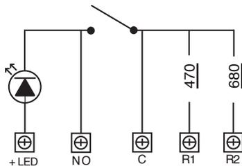
En la parte posterior del punto de llamada hay 5 terminales de tornillo conectados a la PCB interna. Dependiendo de dónde se conecten los cables, el punto de llamada proporciona una resistencia en serie, activa un LED interno o simplemente puede proporcionar un contacto de cierre. Si elige conectar el cable +IN al terminal marcado con +LED, el punto de llamada, cuando esté en funcionamiento, encenderá el LED rojo interno. Alternativamente, si se conecta al terminal NO, el LED no funcionará.
