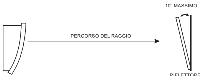
Figura 2b: Fissaggio del riflettore, linee guida
