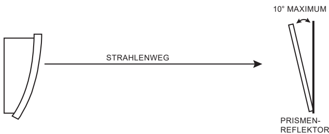
Abbildung 2b: Richtlinien zur Montage des Prismen-Reflektors
