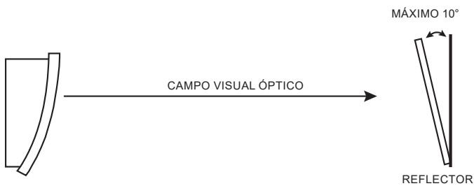
Figura 2b: Instrucciones para el montaje del reflector
