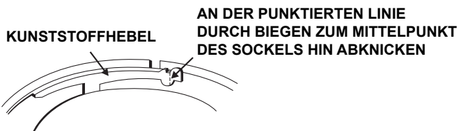
Abbildung 3b: Entfernen des Melders aus dem Meldersockel
