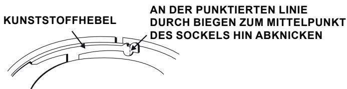
Abbildung 3b: Entfernen des Melders aus dem Meldersockel
